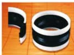
Empaquetadura de pistón de doble efecto con aros de apoyo y de guía ensamblados. El elemento multilabio de caucho esta soportado en ambos lados con aros de plástico de perfil en "V".
