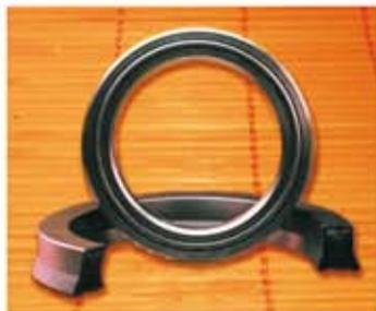
Sellos tipo labial de poliuretano inyectado con o'ring expensor. Diseñados para el sellado de vástagos y pistones de cilindros hidráulicos. Impregnados con disulfuro de molibdeno, lubricante seco que otorga una excelente resistencia a la abrasión.
